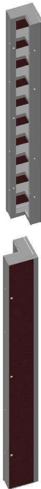
Рис 11. Щит угловой внутренний ЩУВ
