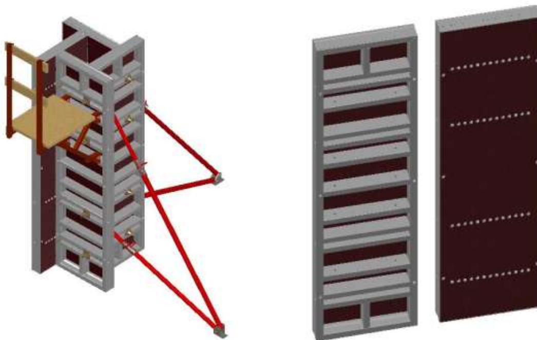
Рис. 13. Опалубка колонн на универсальных щитах
