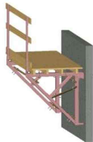
Рис.7. Кронштейн подмостей наружных стен
